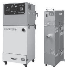
溶接ヒューム回収装置
