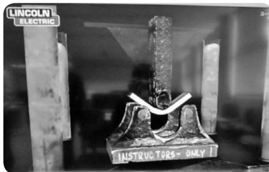
突き合わせ溶接後バーチャル曲げ試験
