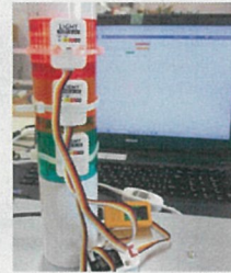
積層信号灯に光センサー取付、I/OHUBユニット
