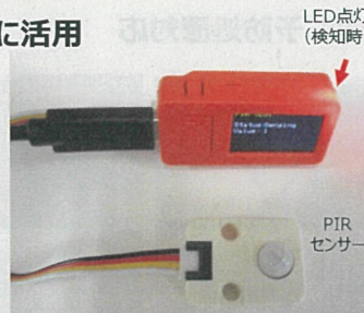
（実施例）センサー検知時、LED点灯
