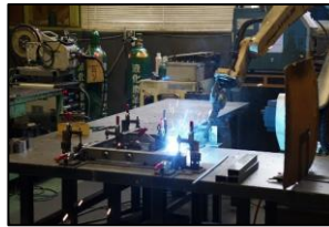
ロボット溶接機
